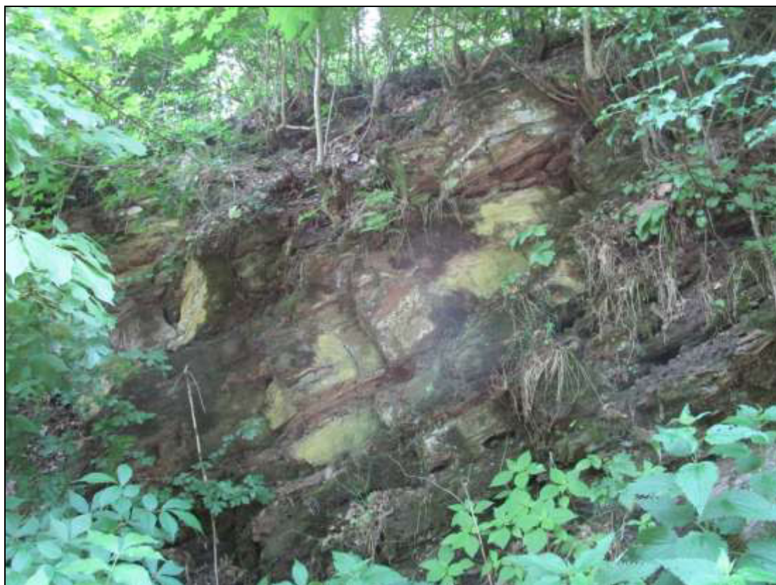
Obr. č. 1 – km cca 9,080, skalní odkryv deskovitých pískovců s vložkami prachovců a jílovců, vrstvy jsou ukloněné cca 30 stupňů k V
